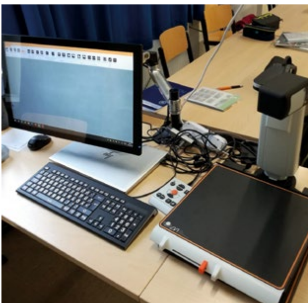
Abbildung 10: Arbeitsplatz mit Notebook, Tastatur, Monitor an einem Schwenkarm, Kamera (rechts) und Lesetisch (Foto: Katja Görlich)
