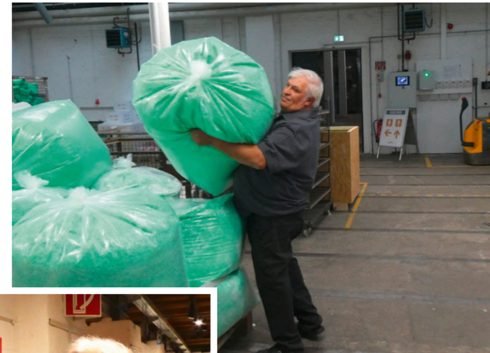
Die Späne, die bei der Produktion der Modelleisten anfallen, werden in große Säcke gesaugt. Irfan stellt sie für den Transport zum Recyclen bereit.
