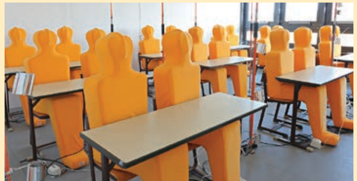
Abb. 8 Innenansicht der Freilandversuchseinrichtung am Fraunhofer IBP Holzkirchen mit Dummies, die sowohl Wärme als auch CO 2 emittieren Quelle: Fraunhofer IBP
