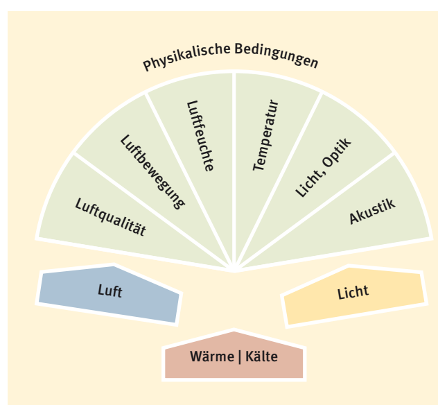
Abb. 1 Diese Faktoren beeinflussen ein behagliches Raumklima. Mit gebäudetechnischen Anlagen lassen sich Luftqualität, Luftfeuchte und Temperatur beeinflussen. Quelle: Fraunhofer IBP/BINE Informationsdienst
